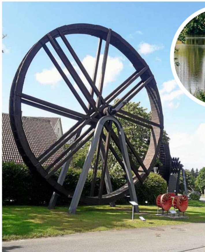
Nachbau am Rand des Kurparks von Clausthal-Zellerfeld: ein Kunstrad mit Feldgestänge und Hubsatz, das Wasser aus den Bergwerken pumpt.
